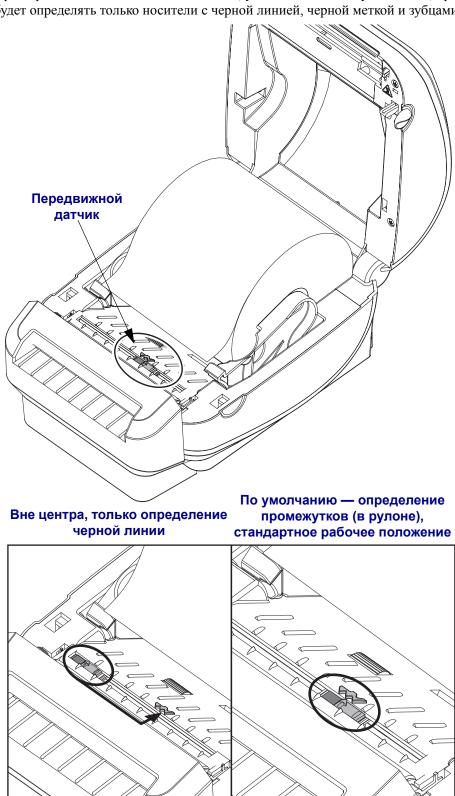
4. Потяните носитель через внутренний паз резака так, чтобы он выступил за пределы передней части принтера. Убедитесь в том, что рулон вращается свободно. Избегайте ошибочной установки рулона на дно отсека носителя. Печатная сторона
