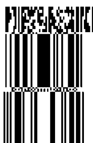
GS1 DataBar Stacked двунаправленный
