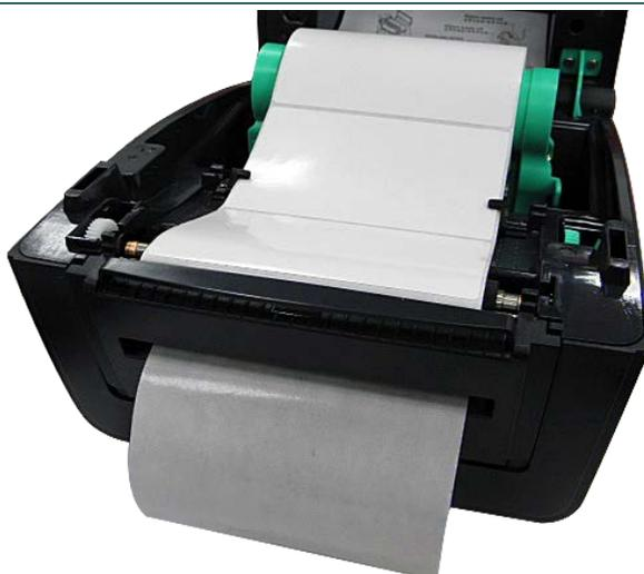
5. Закройте крышку модуля для снятия защитной пленки. Используя DiagTool (Программу диагностики) или функцию меню ЖКД, включите режим снятия защитной пленки.
