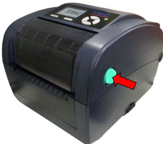
1. Откройте верхнюю крышку принтера, нажав на лапки по обеим сторонам в направлении передней панели принтера, затем поднимите верхнюю крышку на максимальный угол.
