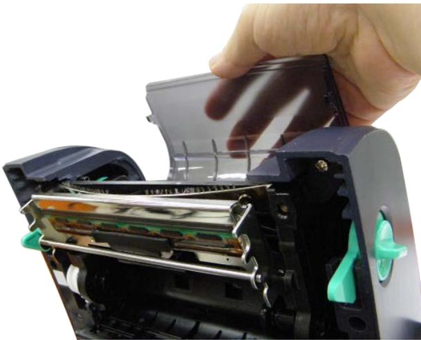
2. Откройте крышку отсека ленты и крышку носителя.
