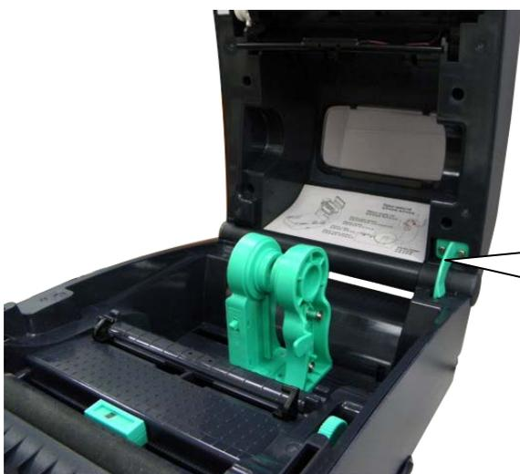
2. Опора верхней крышки на задней панели принтера войдет в зацепление с нижней внутренней крышкой и будет поддерживать верхнюю крышку принтера открытой.
