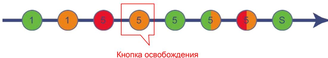
5. Будет выполнена регулировка датчика, измерена длина этикетки и напечатаны внутренние настройки, а затем осуществлен переход в режим дампа.
