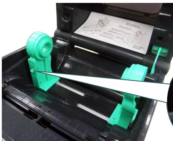
3. Откройте верхнюю крышку принтера и раздвиньте держатели носителя в стороны по ширине носителя. Прижмите вниз рычаг фиксатора держателя носителя, чтобы заблокировать держатель.
