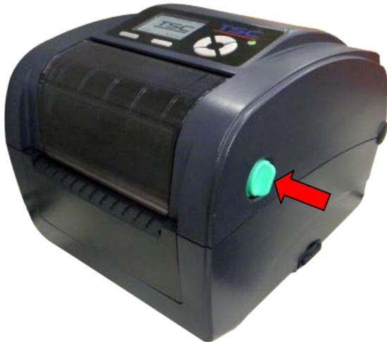
1. Откройте верхнюю крышку принтера, нажав на лапки по обеим сторонам принтера, затем поднимите верхнюю крышку на максимальный угол.
