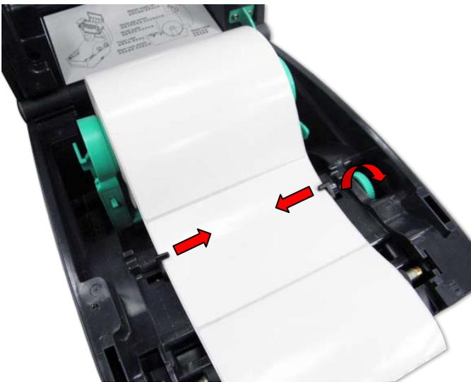
5. Протяните бумагу запечатываемой стороной вверх через датчик носителя и поместите конец рулона этикеток на бумагоопорный валик. Переместите направляющие носителя в соответствии с шириной этикеток, повернув ручку регулятора направляющей.
