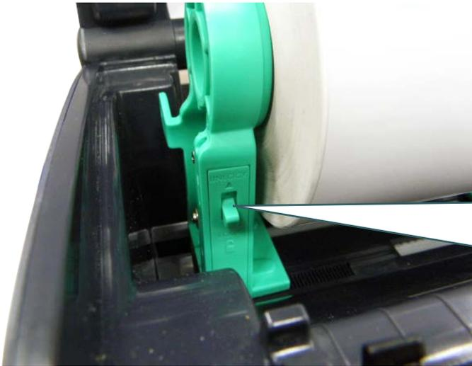
4. Прижмите вниз рычаг фиксатора держателя носителя, чтобы надежно зафиксировать рулон этикеток.
