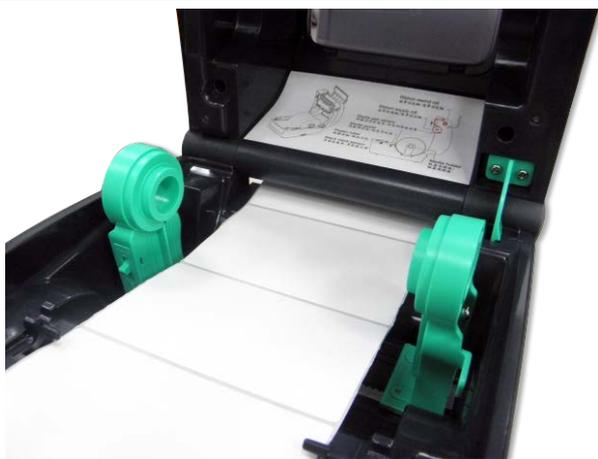
4. Протяните носитель через задний внешний входной лоток для этикеток. И протяните бумагу запечатываемой стороной вверх через датчик носителя и поместите конец рулона этикеток на бумагоопорный валик. Переместите направляющие носителя в соответствии с шириной этикеток, повернув ручку регулятора направляющей.
