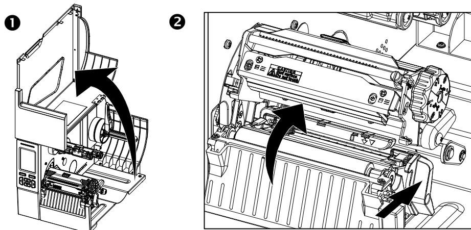
Loading Media/ 安裝標籤/ 安装标签/ メディアの読み込み/ Загрузка носителя/ Medien werden geladen/ Chargement des medias/ Cargando medios/ Caricamento dei media/ Pasang Bahan/ تحميل الوسائط
