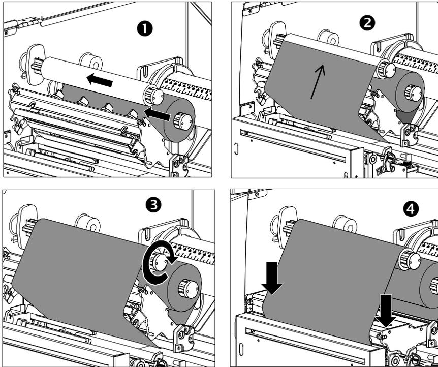
Remove Used Ribbon/移除碳帶/移除碳帶/中古リボンを取り外す/ Удалить использованную
