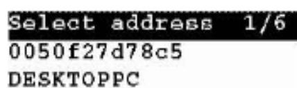
Названия и адреса устройств будут отображены на дисплее терминала один за другим. Для перемещения вниз нажмите клавишу Q2, для перемещения вверх – Q1. Для выбора определенного устройства нажмите кнопку сканирования.
