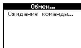
Данный режим предназначен для обмена данными с ПК. Для обмена достаточно перейти в этот режим, после чего выгрузка, загрузка или очистка справочников с ПК должны быть вызваны со стороны ПК.
