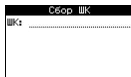
Оператор производит сканирование штрихкода товара. Если считанный ШК найден в базе данных, то к имеющемуся в памяти ТСД количеству (поле «Кол-во» справочника «Штрихкоды») прибавляется 1. В противном случае считанный штрихкод сохраняется в базе данных в таблице «Штрихкоды» с количеством 1 в соответствующем поле.
