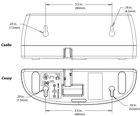
При наличии металлической или деревянной стойки просверлите в ней установочное отверстие диаметром 2,38 мм и с помощью входящего в комплект винта № 6 х 1 прикрепите зарядное устройство с несколькими отсеками к стене. Для закрепления винтов непосредственно в стене из сухой кладки используйте набор анкеров/винтов для гипсоволоконных листов, например указанный ниже. Источник электропитания крепится отдельно.
