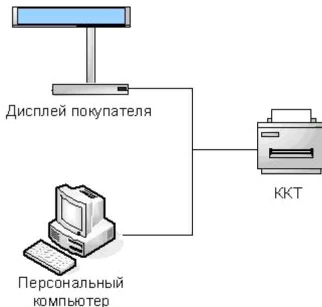
Рисунок 3. Подключение управляющих устройств к ККТ
