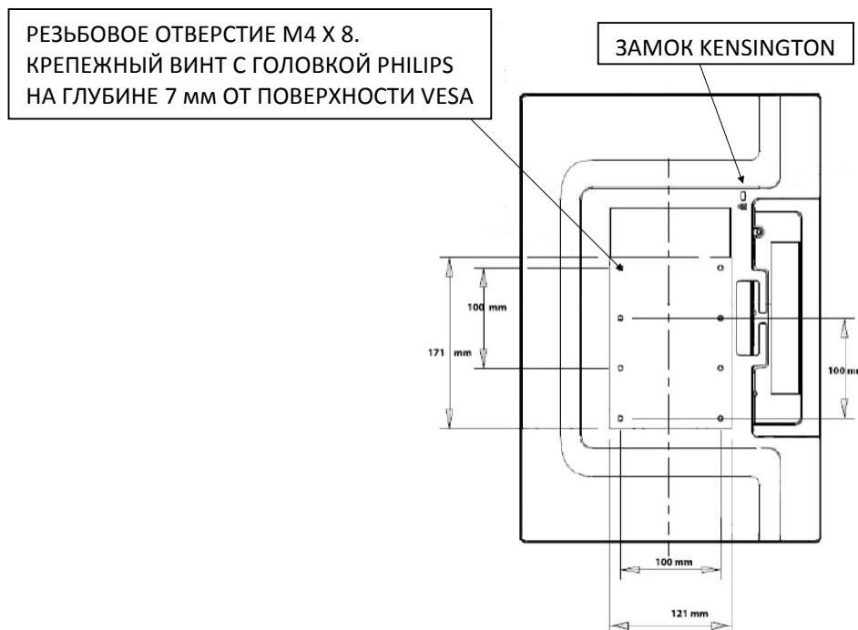
Выше показан вид монитора сзади в вертикальной ориентации
