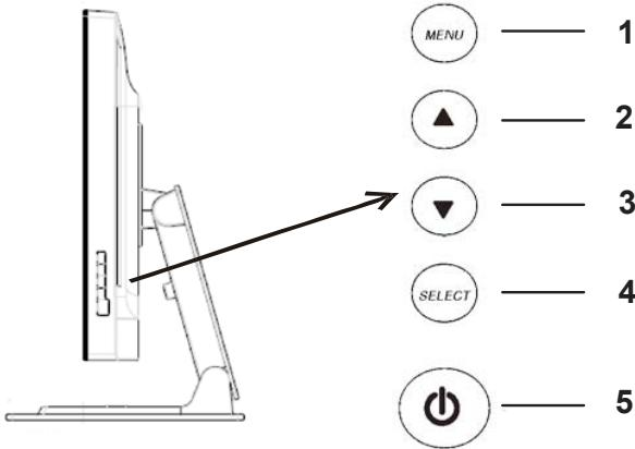
Блок управления отображением (On-Screen Display - OSD) расположен сбоку монитора, как показано выше.
