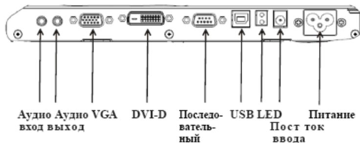
Громкость и выключение звука можно регулировать с помощью выбора “Audio” (Аудио) из меню блока управления отображением выполняемых функций на экране (On-Screen Display - OSD), как описано на страницах с 16 по 18.
