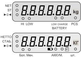
Рисунок 4.2 – Вид дисплея с высвечиваемыми сегментами и указателями Таблица 4.1 – Описание назначения клавиш
