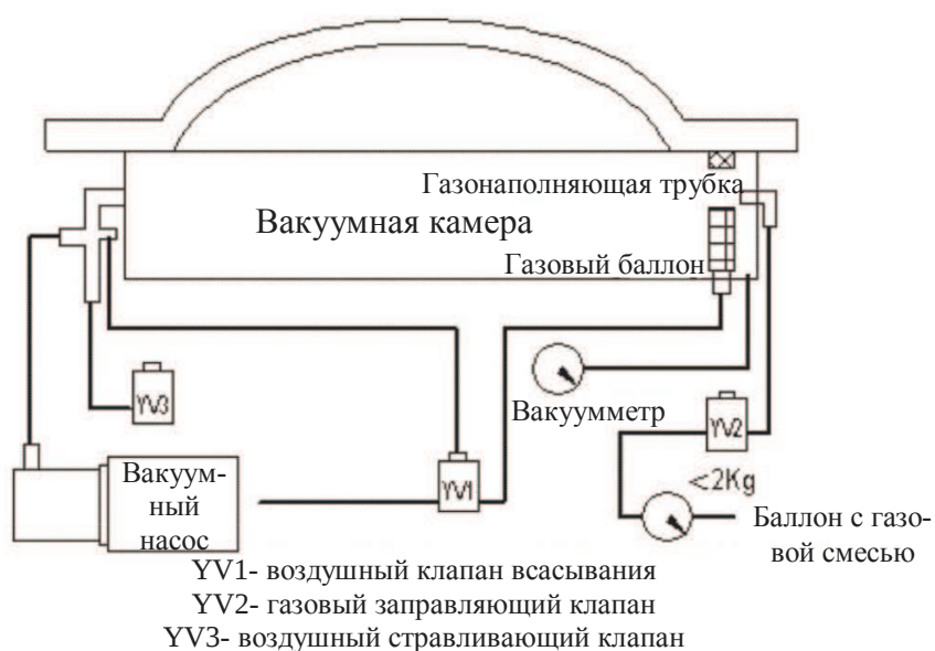
Схема вакуумного упаковщика с системой газации
