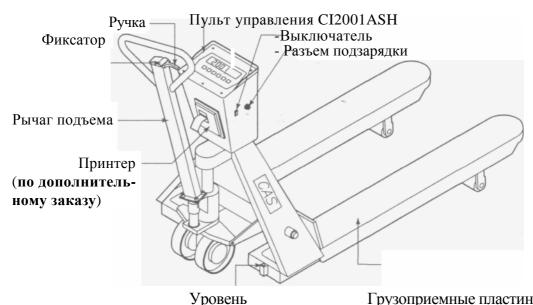
Грузоприемные пластины (вилочного типа)
